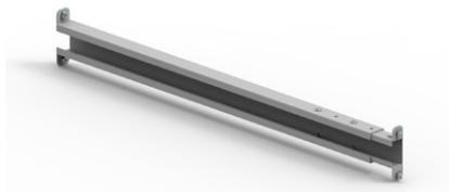
Teleskopierbares Verbindungsstück für SK/ SL/SM/ TL/TM und TT Hubsäulen. Die Traverse lässt sich einfach in die Nuten (8 mm breit) der Hubsäule schieben und mit einem Sechskantschlüssel festklemmen.
