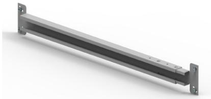
Teleskopierbares Verbindungsstück für SF/SK/ SL/ SM/ TL/TM und TT Hubsäulen. Die Traverse lässt sich einfach in die Nuten (8 mm breit) der Hubsäule schieben und mit einem Sechskantschlüssel festklemmen.
